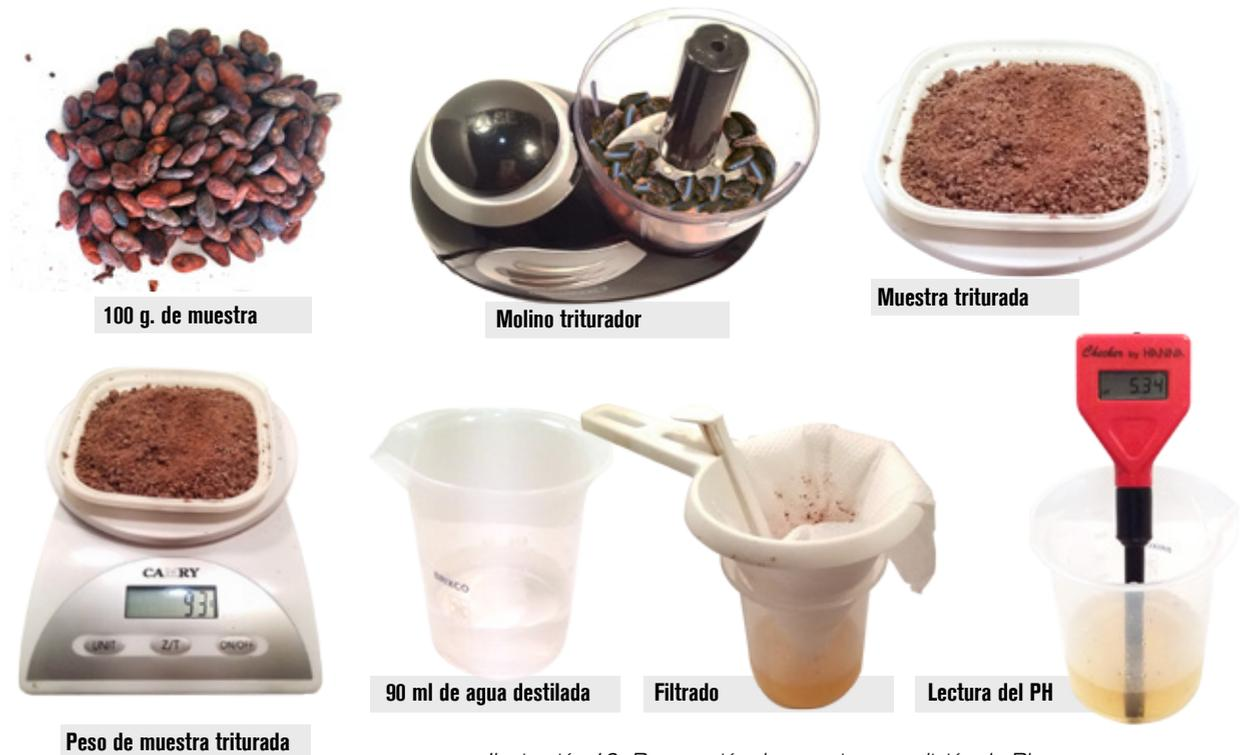
Ilustración 19. Preparación de muestra y medición de Ph.
