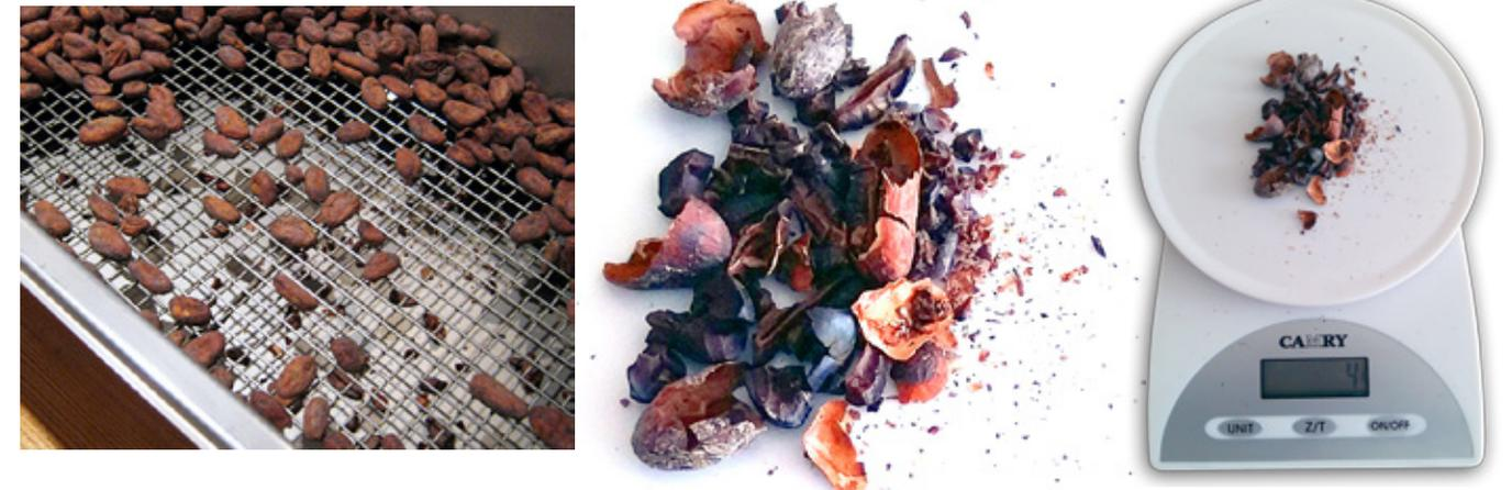
Ilustración 6. Tamizado, clasificación y pesaje de residuos y material extraño
